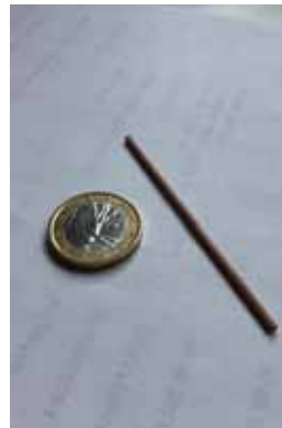
Dimensioni provino \phi = 2\text{mm} , h = 60\text{ mm}
